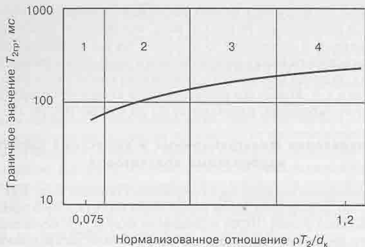
Рис. 5. Схематическое представление зависимости граничного значения T_{2гр} от нормализованного отношения \rho T_2/d_k (на основе данных [4]): 1 – область очень низких отношений; 2 – область средних отношений; 3 – высокие отношения; 4 – очень высокие отношения
